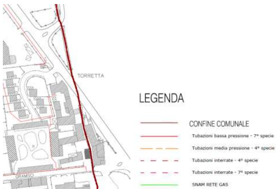
Figura 14: Rete gas (fonte piano dei servizi PGT del comune di Arese)
