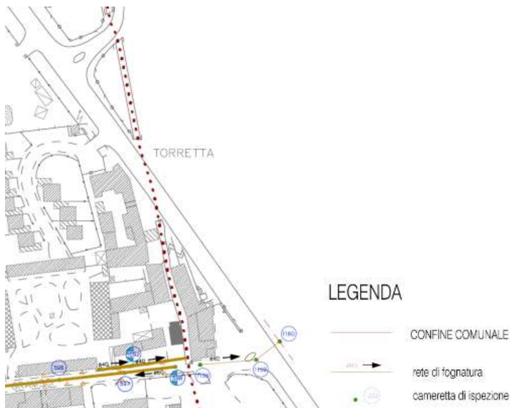
Figura 15: Rete fognatura (fonte piano dei servizi PGT del comune di Arese)
