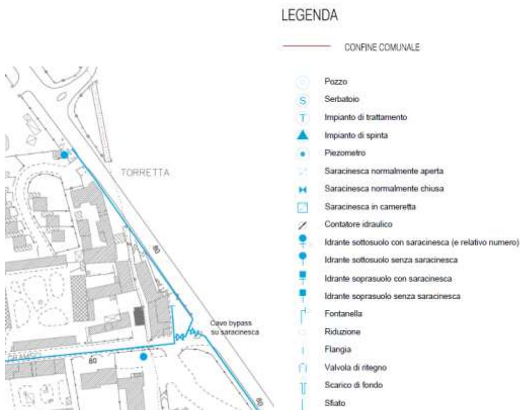
Figura 12: Rete acquedotto (fonte piano dei servizi PGT del comune di Arese)
